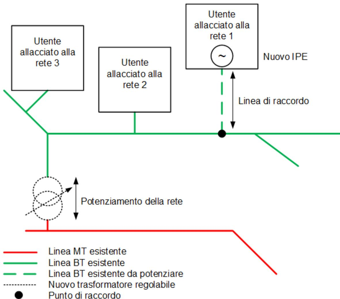
**Esempio 2c:** Il nuovo IPE non necessita del potenziamento della linea a bassa tensione (linea BT); per rispettare le prescrizioni tecniche basta un regolatore di tensione. Il potenziamento della linea di raccordo fino al punto di raccordo è a carico del produttore. Il nuovo regolatore di tensione è considerato un potenziamento della rete necessario ai sensi dell'articolo 22 capoverso 3 OAEI.
