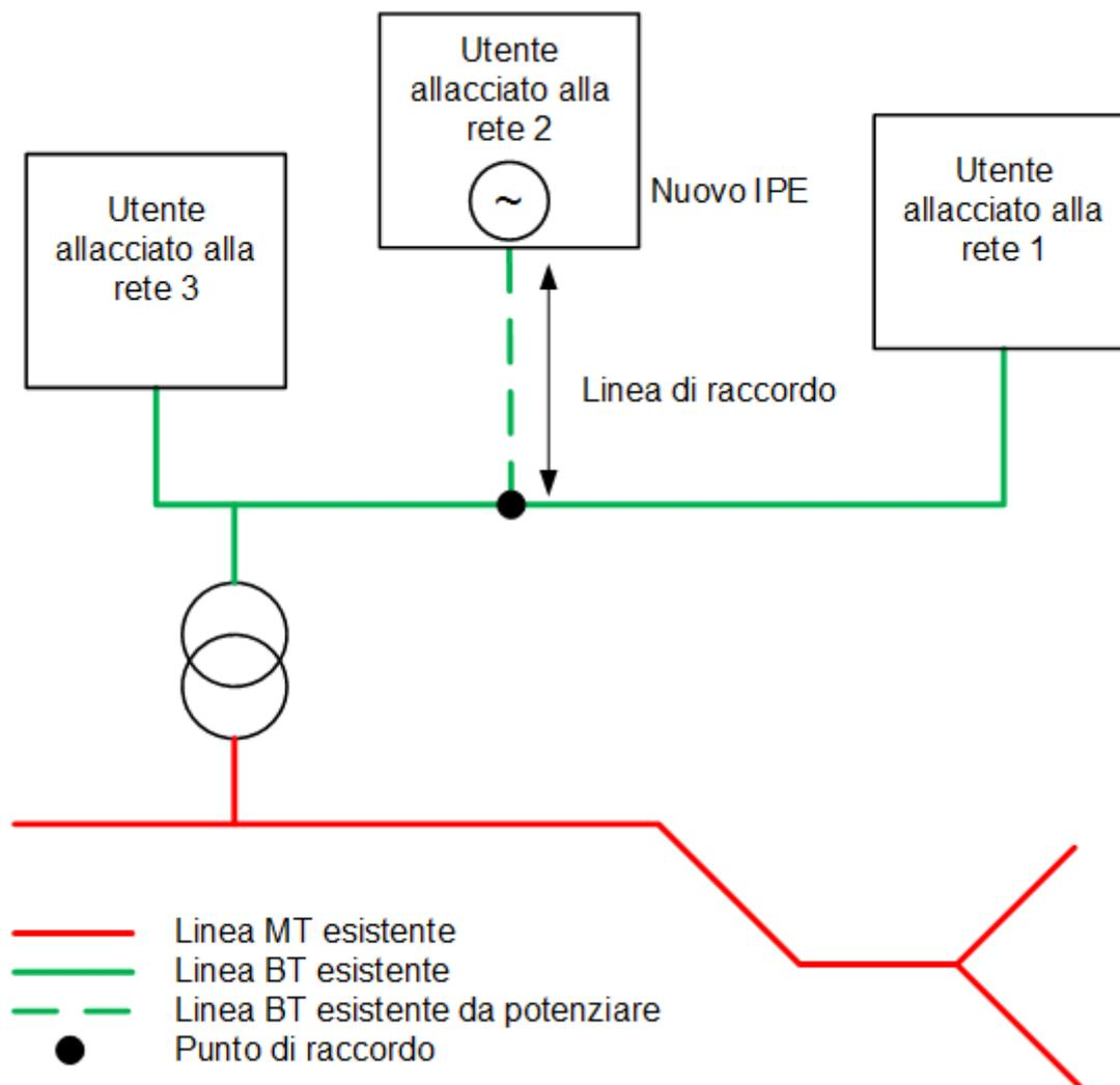
**Esempio 2a:** Il nuovo IPE necessita del potenziamento della linea a bassa tensione (linea BT) fino alla cabina di trasformazione. Il potenziamento della linea di raccordo fino al punto di raccordo è a carico del produttore. Il potenziamento della linea BT dal punto di raccordo fino alla cabina di trasformazione è considerato un potenziamento della rete necessario ai sensi dell'articolo 22 capoverso 3 OAEI.
