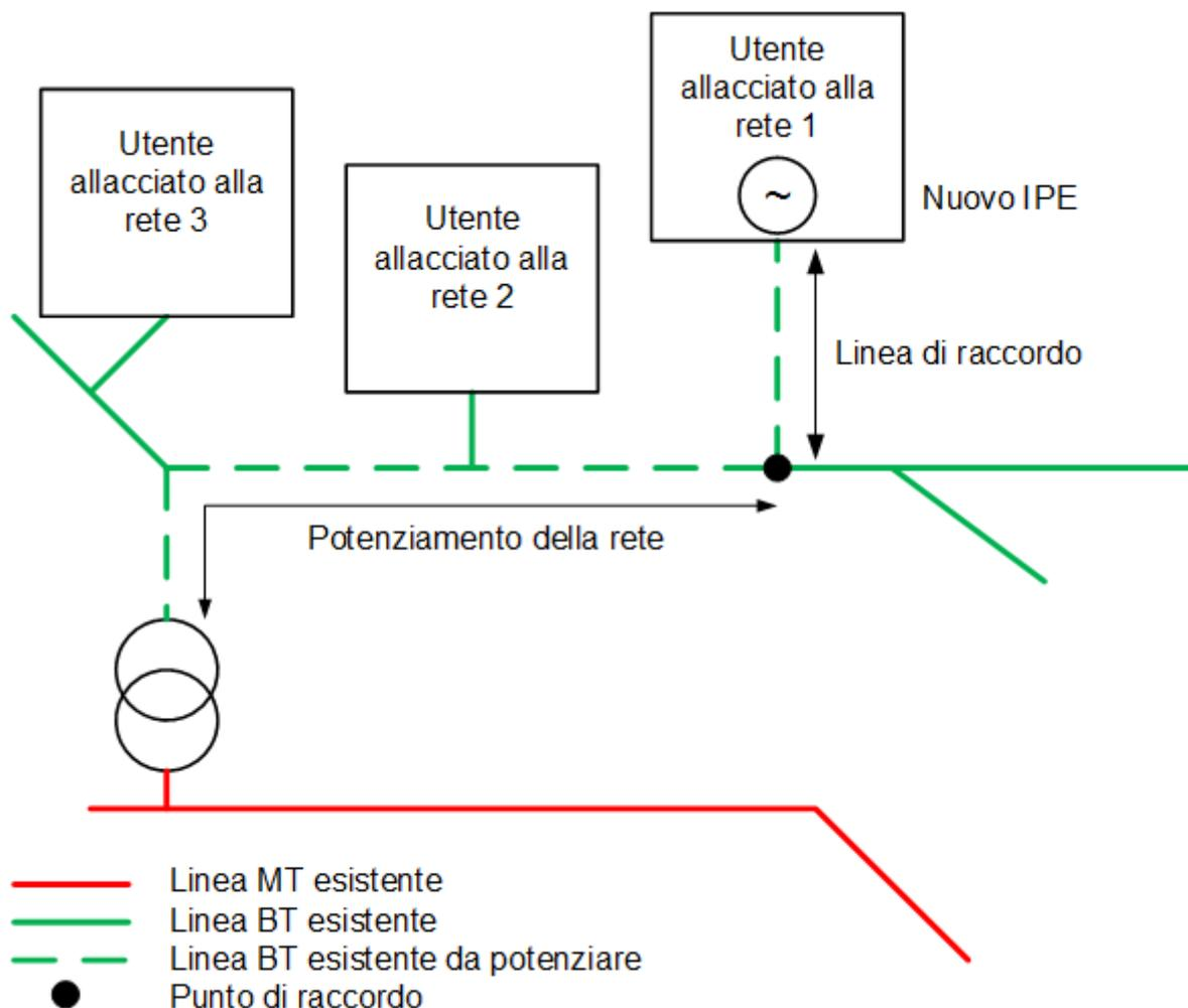
**Esempio 2b:** Il nuovo IPE non necessita del potenziamento della linea a bassa tensione (linea BT); per rispettare le prescrizioni tecniche basta un trasformatore regolabile. Il potenziamento della linea di raccordo fino al punto di raccordo è a carico del produttore. Il nuovo trasformatore regolabile è considerato un potenziamento della rete necessario ai sensi dell'articolo 22 capoverso 3 OAEI.
