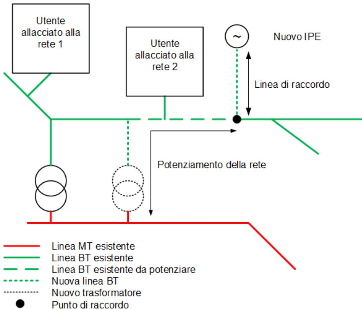
**Esempio 4:** Il nuovo IPE necessita di un raccordo a media tensione. La nuova linea di raccordo a media tensione da realizzare, la nuova cabina di trasformazione come pure la nuova linea a bassa tensione sono considerate linee di raccordo e sono a carico del produttore. Non si è in presenza di un potenziamento della rete necessario ai sensi dell'articolo 22 capoverso 3 OAEI.
