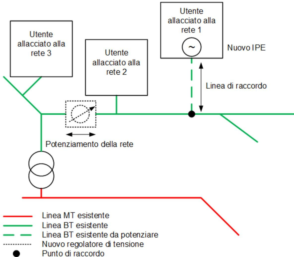
**Esempio 3:** Il nuovo IPE necessita di un potenziamento ovvero in parte di una nuova linea a bassa tensione (linea BT) fino alla cabina di trasformazione e di un nuovo trasformatore. La nuova linea di raccordo da realizzare fino al punto di raccordo è a carico del produttore. Il potenziamento della linea a bassa tensione dal punto di raccordo come anche la nuova linea a bassa tensione e il nuovo trasformatore sono considerati necessari ai sensi dell'articolo 22 capoverso 3 OAEI.
