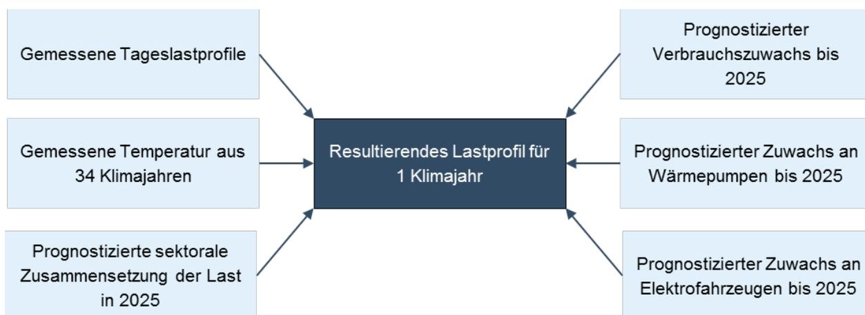
Abbildung 9: Eingangsdaten für die Lastmodellierung.
