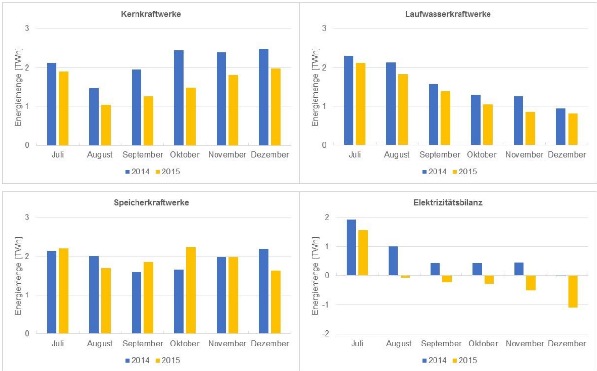
Abbildung 2: Monatliche Energieproduktion der Kernkraftwerke, Laufwasserkraftwerke, Speicherkraftwerke sowie Elektrizitätsbilanz (positiv: Import, negativ: Export) der Schweiz (Quelle: BFE)
