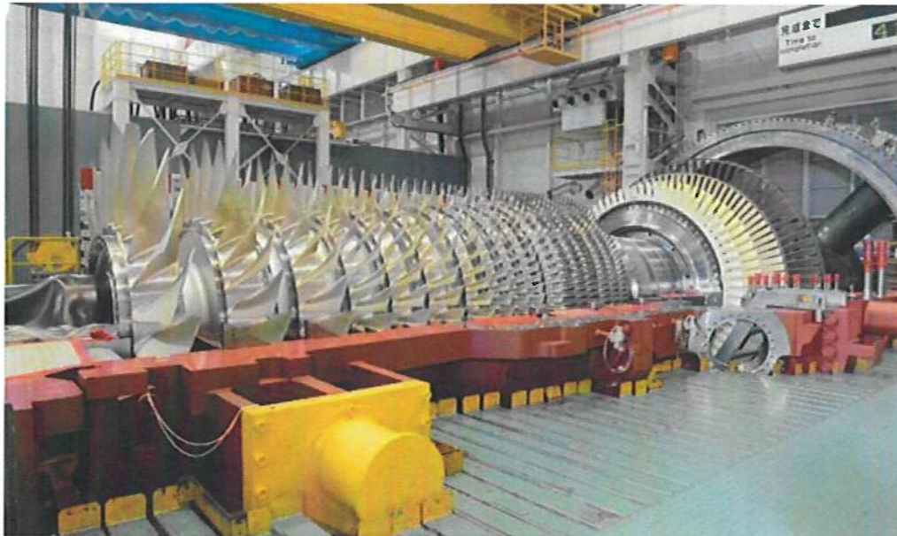
Abbildung 3-5 F-Klasse Gasturbine mit offenem Gehäuse (Quelle: Mitsubishi Power, M701F)
